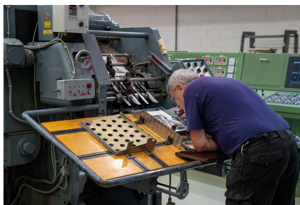
Un technicien est chargé de détecter avec minutie le moindre défaut d'impression et de calage (contrôle d'un bloc-feuillelet lors de la photographie prise par Adrien Golinvaux).
