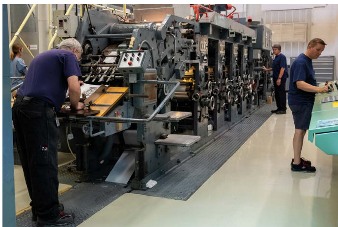
Vue de la presse pour impression en héliogravure (machine d'impression mixte héliogravure et taille-douce), photographie d'Adrien Golinvaux.
